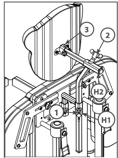
**!** **WARNUNG** Die maximale Verstellung ist erreicht, wenn das Rohrende bündig mit der Führung (H1 oder H2) abschließt.
