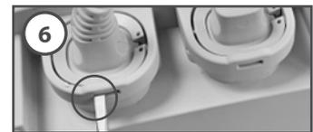
6. Schließen Sie zuerst den Akku [A] und dann die Steuereinheit [B] an das Gerät an und stellen Sie sicher, dass die Verriegelungsclips vollständig eingerastet sind (Bild 7). Wenn die Clips nicht vollständig eingerastet sind, ragt die Lasche (gezeigt auf dem Bild 2) heraus.
